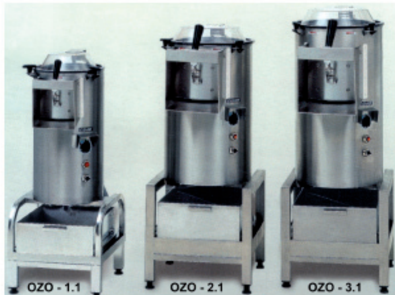
FOTOGRAFIA 2. Przykłady maszyn do obierania ziemniaków i warzyw: typ OZO.1.1 - wydajność 140-210 kg/h, typ OZO.2.1 - wydajność 240-360 kg/h, typ OZO.3.1 - wydajność 350-540 kg/h (producent: Łódzkie Zakłady Metalowe LOZAMET)
