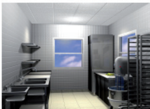
RYSUNEK 24. Boks obróbki wyrobów mącznych (wizualizacja rozwiązania modelowego); wyposażenie: 1- zlew 2-komorowy, 2 - stół chłodniczy, 3 - półka, 4 - waga do 10 kg, 5 - szafa chłodnicza 700 l, 6 - maszyna wieloczynnościowa, 7 - regał jezdny na pojemniki GN, 8 - pojemnik na odpady, 9 - umywalka
