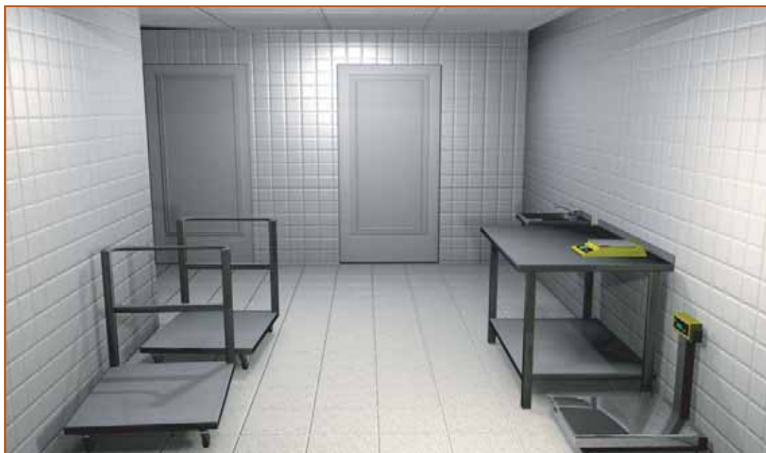
Рисунок 2. Участок приёмки (согласно проекту Западной Больницы в Гродиске Мазовецком). Оборудование: складские весы до 500 кг, стол, настольные весы до 10 кг, тележка, раковина.
